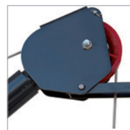
Top limit switch Fin de course supérieure
